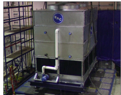
Prueba de una PF2 en plataforma de vibración
